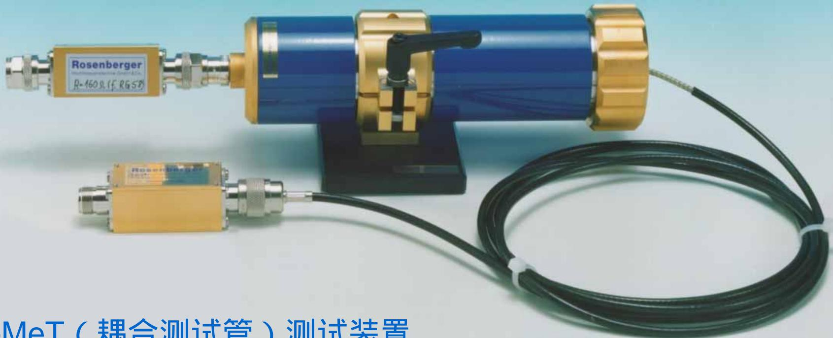
CoMeT (耦合测试管) 测试装置
