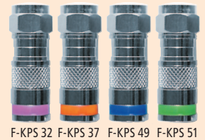
F-KPS 32 F-KPS 37 F-KPS 49 F-KPS 51 Kompressions-F-Stecker von Interkabel mit gleicher Baulänge für verschiedene Kabeldurchmesser (Zange muss nicht „eingestellt“ werden)
