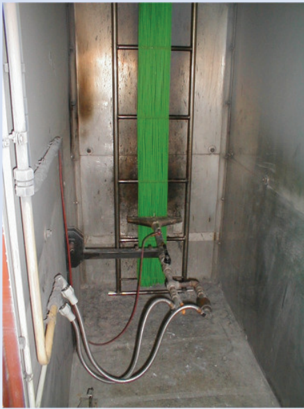
Bündeltest nach EN 50266-1 bzw. IEC 60332-3-10
