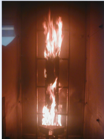
Bündeltest nach EN 50266-1 bzw. IEC 60332-3-10
