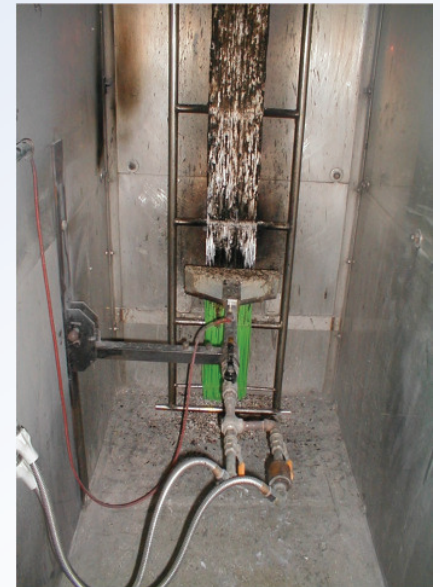
Bündeltest nach EN 50266-1 bzw. IEC 60332-3-10
