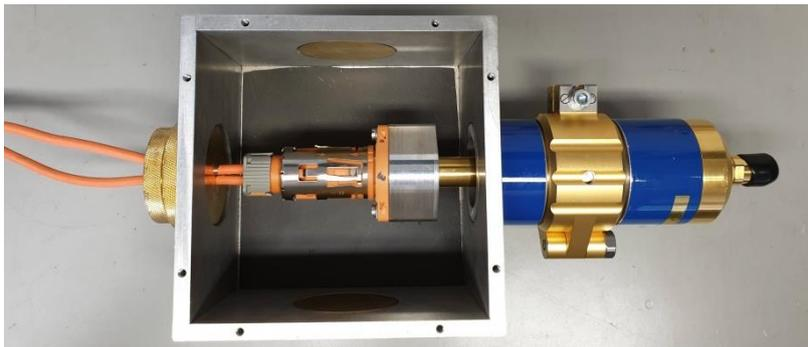
**Bild 10: Gerader HV Stecker in triaxialer Zelle**
