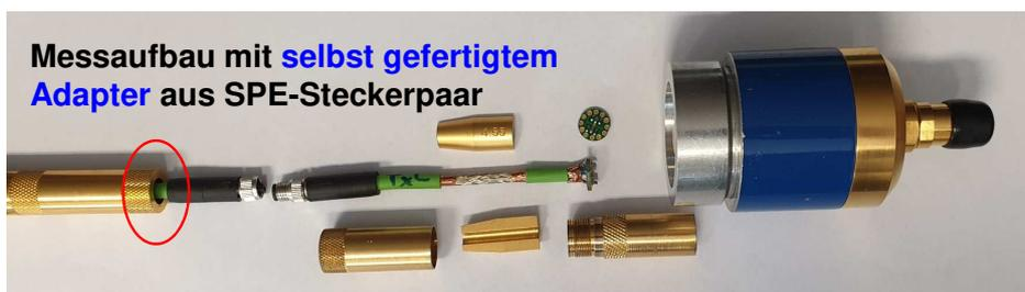
Messaufbau mit **selbst gefertigtem Adapter** aus SPE-Steckerpaar
