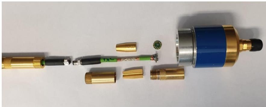
**Bild 6: Anschluss am Messkopf mit Rohr-in-Rohr und Messadapter aus paarigem Stecker**
