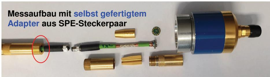
Messaufbau mit selbst gefertigtem Adapter aus SPE-Steckerpaar
