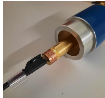
Abbildung 2: Messaufbau eines SPE-Steckverbinders
