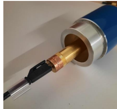
Abbildung 2: Messaufbau eines SPE-Steckverbinders
