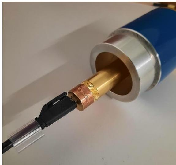
**Bild 2: Messaufbau eines SPE-Steckverbinders**
